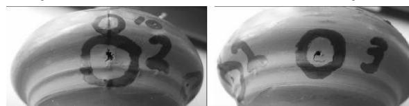
图9 B被检对象的2个陡波击穿孔
